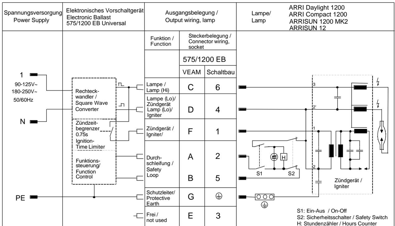
Abb./Fig. 1b: Anschlußbelegung 1200 W /
